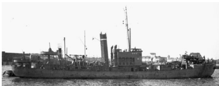
Weiter Ausbaustufe Die Masten wurden entfernt. Ein Funkmast wurde auf die Brücke gesetzt. Die Brücke wurde gepanzert. Es kamen weitere Flak-Geschütze hinzu.
